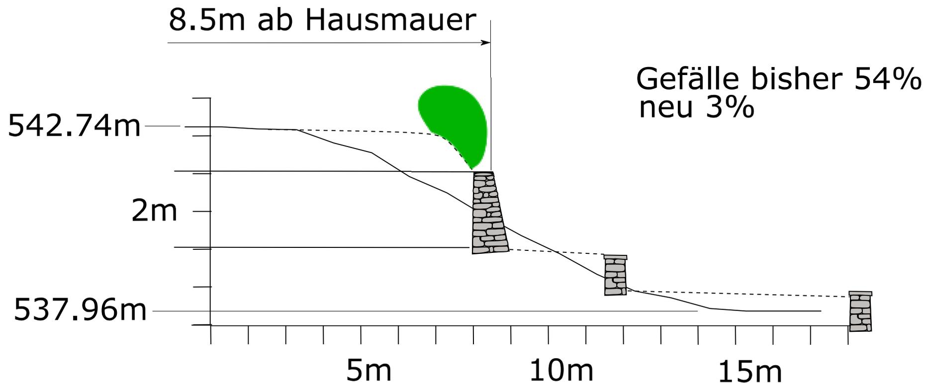
Skizze: Die Trockenstein Mauer wird mitte Hang platziert damit der Aushub unterhalb der Trockenmauer zur Füllung oberhalb der Mauer verwendet werden kann. Die Hecke und Bepflanzung oberhalb der Mauer, verhindert den Zugang zur Absturzkante. Die beiden kleinen Trockenmauern sind zwischen 0.5-1m hoch und benötigen keine Absturzsicherung.
